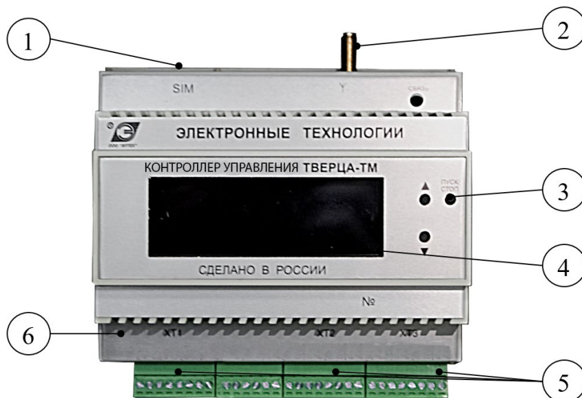
Рисунок 1.4 Внешний вид контроллера управления «Тверца-ТМ-02». На рисунке цифрами обозначены: 1 – разъем для установки SIM-карты; 2 – разъем (SMA) для подключения антенны; 3 – кнопки управления; 4 – LED дисплей; 5 – разъемы измерительных и цифровых интерфейсов; 6 – индикатор наличия напряжения питания.
