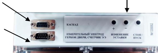
Рисунок 1.6 Размещение разъемов и кнопок управления на контроллере силового преобразователя
