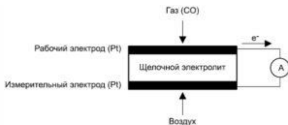
Рис. 1. Принцип действия электрохимического датчика газа
